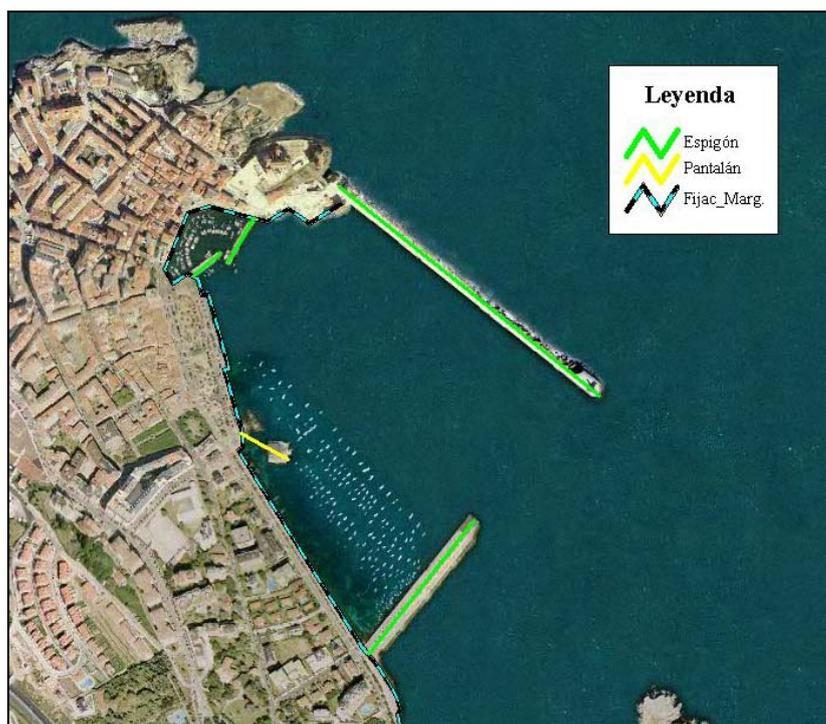
Figura 4. 14. Alteraciones hidrodinámicas y fijaciones de margen en Castro Urdiales.
