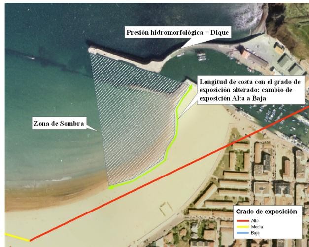
Figura 3. Ejemplo de zona de sombra de una presión hidromorfológica y longitud de costa con el grado de exposición alterado.
