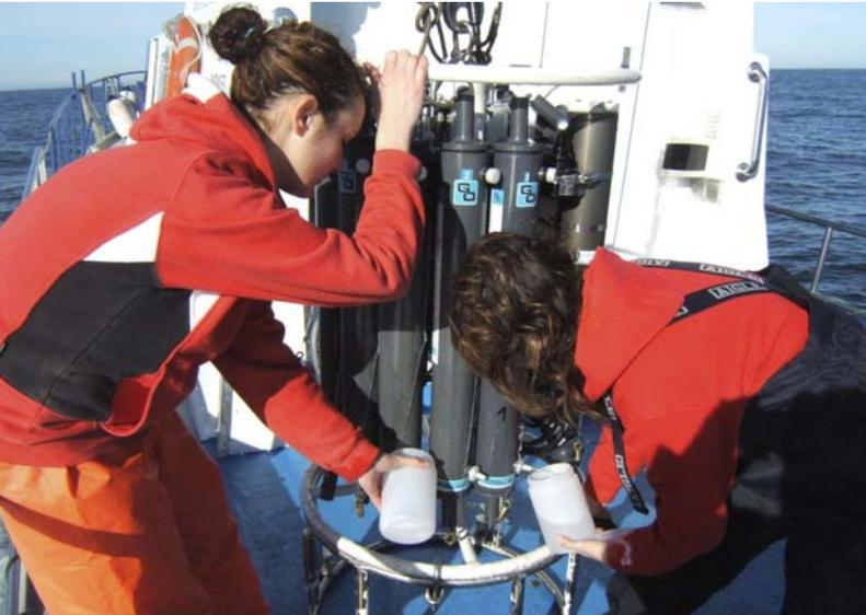
Muestreo en aguas costeras a bordo de embarcación oceanográfica
